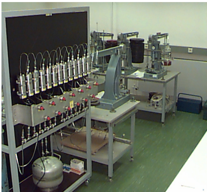
Figure 3: Experimentele opstellingen gebruikt voor de directe meting van radionuclide migratie parameters.
