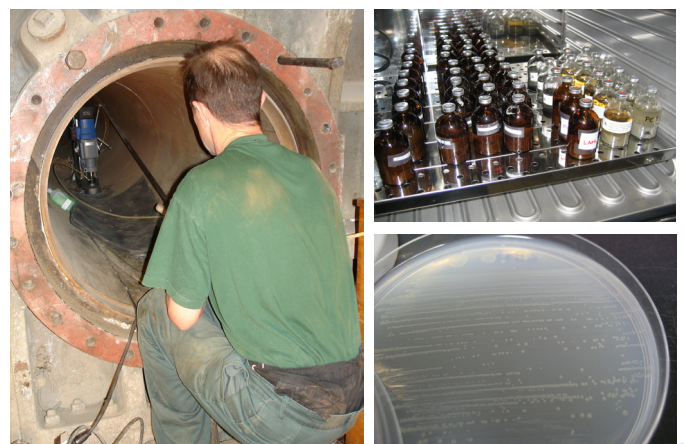
Onderzoek naar microbiële activiteit in het ondergrondse laboratorium HADES, 225 meter onder de SCK•CEN-site in Mol. Links: Boren van kleistalen. Rechts boven: Cultivatie van bacteriën afkomstig uit Boomse klei. Rechts onder: Karakterisering en identificatie van bacteriën.
