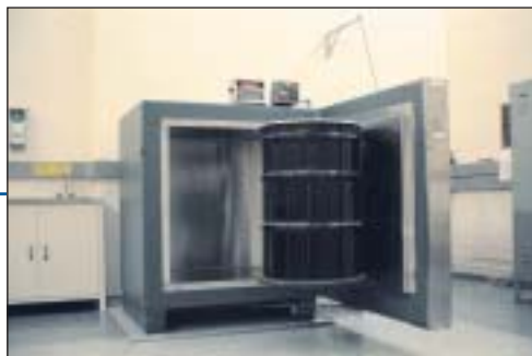
Het SCK•CEN gebruikt voor afval met lage activiteit een Q 2 test systeem voor het bepalen van de radioactiviteit.
