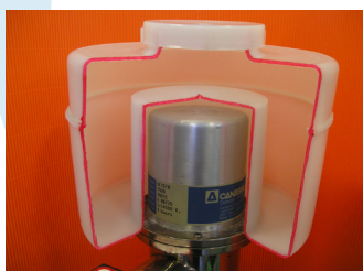
Links: Doorsnede van een marinelli™ beker op een Ge-detector Rechts: Bronbereiding met een pycnometer
