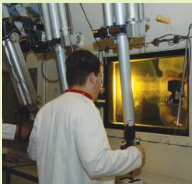
↑ Opérateur de cellules blindées utilisant les télémanipulateurs lors de recherches sur des matériaux hautement radioactifs au LHMA.
