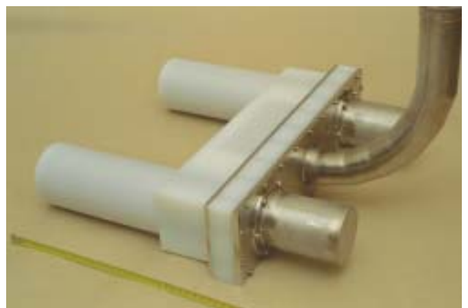
↑ Le détecteur FORK, développé par le SCK•CEN, mis en œuvre dans le cadre de «safeguards» pour la caractérisation des matières fissiles utilisées.
