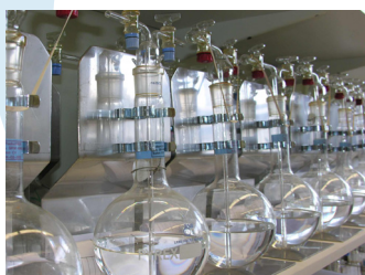
Gauche: Préparation d'un échantillon d'eau pour la détermination du radium-226. Droit: Flacons de comptage pour mesure par scintillation liquide.
