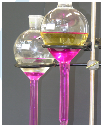
Extraction en phase liquide de l'iode (détermination de l'iode-131 dans le lait).
