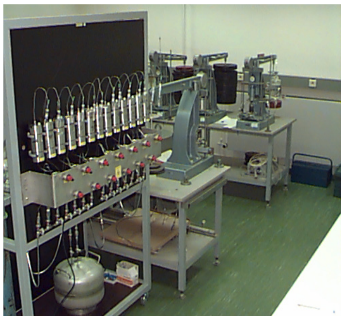
Figure 3: Experimentele opstellingen gebruikt voor de directe meting van radionuclide migratie parameters.
